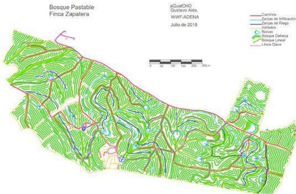
20. Ejemplo de plan de la tierra en línea clave de la finca la Zapatera (Badajoz)
